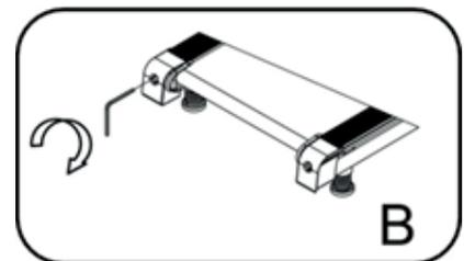
3. Ajuste el cinturón después de un período de tiempo de uso. Saque el interruptor, gire el perno de ajuste izquierdo y derecho 1/4 en el sentido de las agujas del reloj, luego vuelva a comenzar a correr para verificar el ajuste del cinturón hasta que el cinturón esté bien ajustado. IMAGEN - C
